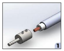
PREPARE THE CABLE END, STRIP THE INSULATION
