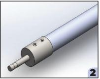
END THE CABLE, TIGHTEN THE CONNECTOR SCREWS
